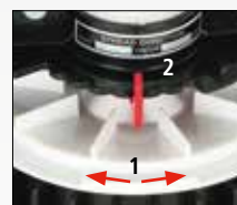
Verstelbare uitwerpopening (1), roermechanisme (2)
