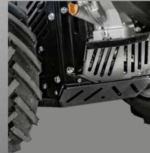
Extreme **Bodenfreiheit, Wickelschutz** an den Achsen, kompakt und mit **niedrigem Schwerpunkt** für Arbeiten auf engstem Raum.
